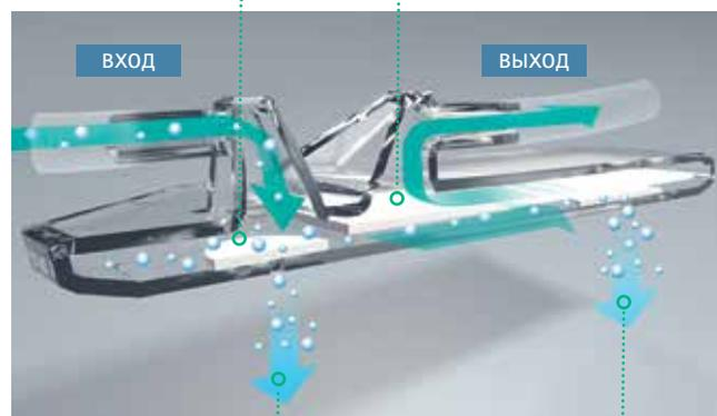
Инфузионные фильтры предотвращают попадание воздуха благодаря двум 0,02 мкм гидрофобным мембранам из полиэфирсульфона. Они обеспечивают надежное удаление воздуха независимо от положения фильтра во время инфузии.
