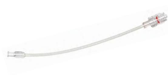
Соединительная трубка длиной 200 мм, выдерживает давление 3,4 МПа (500 psi), оснащена вращающимся коннектором Луер-лок male и коннектором female. Предназначена для подключения вспомогательного оборудования.
